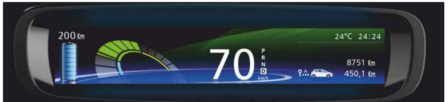
La original pantalla TFT del cuadro de instrumentos del ZOE permite al conductor consultar parámetros relacionados con la conducción y la autonomía del vehículo.
